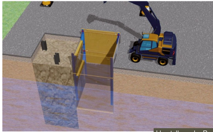
Herstellung der Baugrube mit Verbaubox und Bagger
