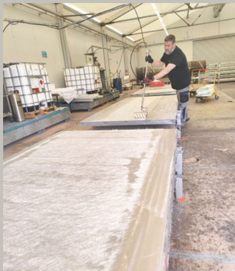
Herstellung der GFK-Platten mit Glasfaser- matten und Harz. 40 bis 60 Tonnen Glas werden am Unternehmenssitz jährlich verarbeitet. | Foto: B_I/Valdix
