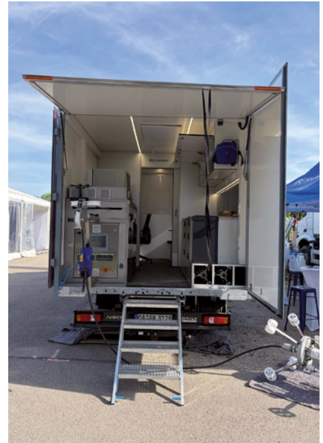
Im Fahrzeug verbaute IBG UV/IR smartcure 5.0 | Fotos: IBG HydroTech
