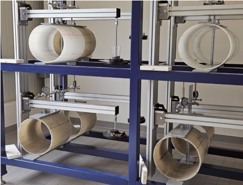
Messung der Verformung von Schlauchlinern im Langzeit-Scheiteldruckversuch | Foto: Siebert + Knipschild GmbH
