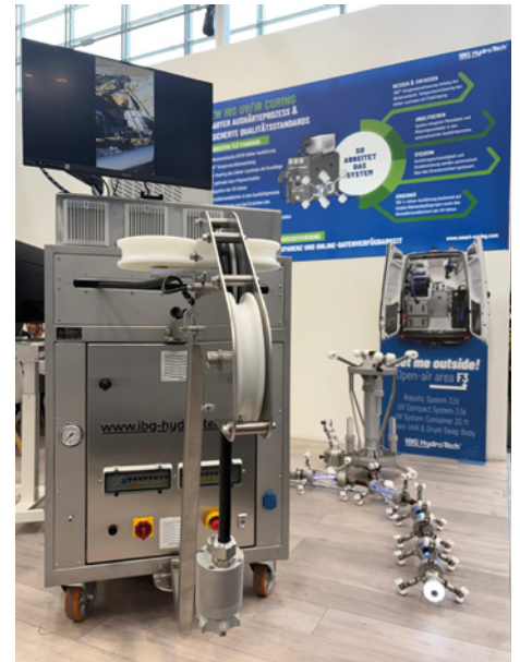
Die neue UV-Anlage, hier ausgestellt in München auf der IFAT, ermöglicht eine parametergesteuerte Aushärtung von UV-Linern mit Industrie-5.0-Standard.
