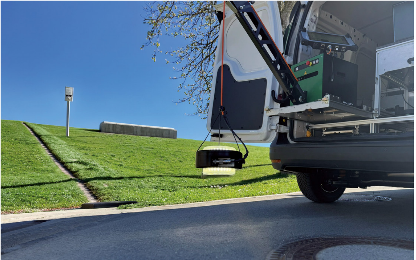
Der Schachtscanner von Rausch kommt hier gleich zum Einsatz. Es braucht nur noch eine Person, die die Abdeckung öffnet und den Scanner startet.
