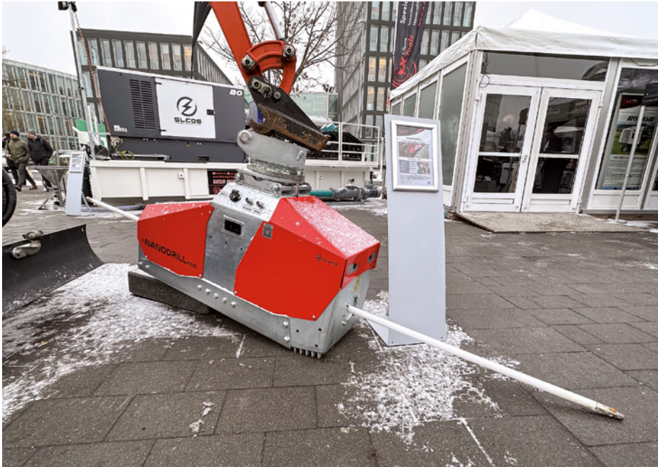
Der neue Nanodrill 4030, montiert an einem Bagger. Das Kunststoffgestänge hat einen 3 m Biegeradius. | Foto: L-Team X-Tools
