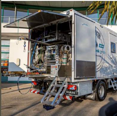
Full-HD-Inspektionsfahrzeug mit integriertem Hochdruckspüler | Foto: JT-elektronik
