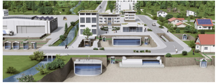
Mit den Mall-Lösungen für die Schwammstadt kann Regenwasser am Ort des Anfalls gesammelt, behandelt, genutzt, verdunstet und versickert werden. | Foto: Mall GmbH
