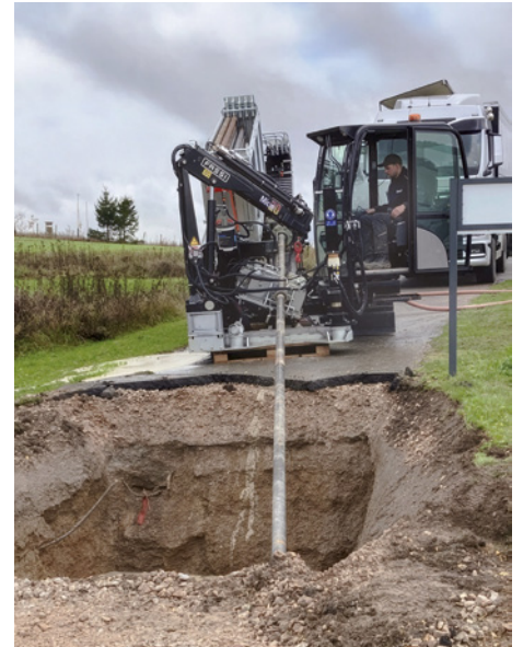
Das vollautomatische Gestänge-Wechselsystem entlastet den Bediener und automatisiert die Abläufe. Ein fernbedienbarer Ladekran ist eine sinnvolle Option für sicheres Handling von Gestängen, Boxen und Zubehör.
