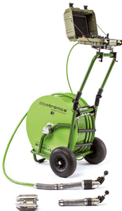
Das Robotersystem eCutter lateral: Roboterkopf 75 (rechts, für DN 75-125), Roboterkopf 100 (Mitte, für DN 100-200), Verspanneinheit (links, für Erweiterungen bis DN 300), Kabeltrommel mit integriertem Schaltschrank und Bedienkoffer mit 12"-Live-Monitor.
