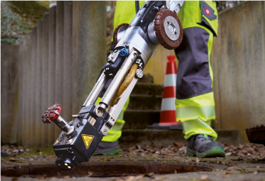
Vor zehn Jahren wurde der erste MicroGator von IBAK Robotics auf den Markt gebracht. Seither überzeugt der elektrische Fräsroboter durch seine Zuverlässigkeit im täglichen Einsatz. | Foto: IBAK
