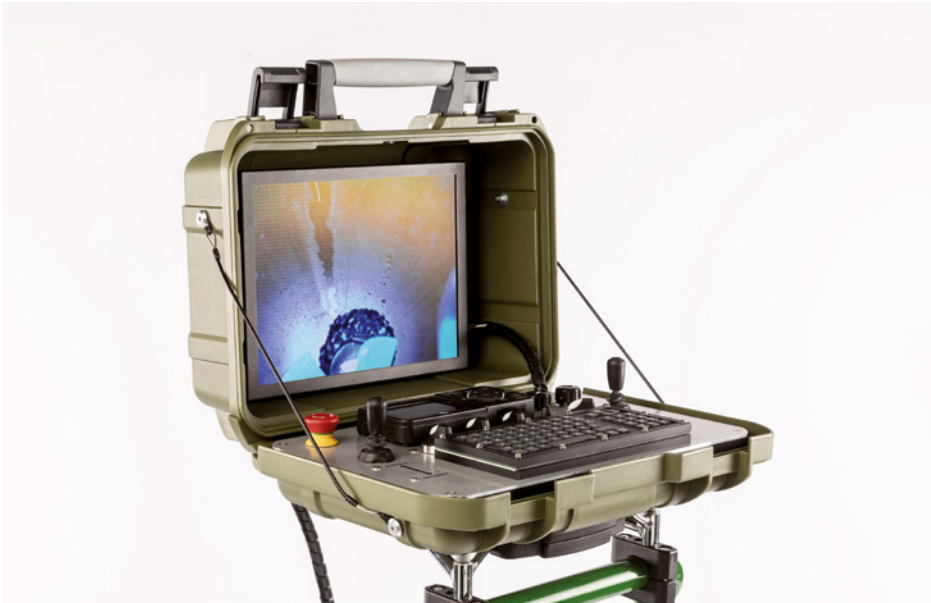
Der kompakte Bedienkoffer des eCutter lateral: Über den 12"-Monitor und den Front- und Rückkameras am Roboter lässt sich der eCutter lateral optimal bedienen. | Fotos: Pipetronics
