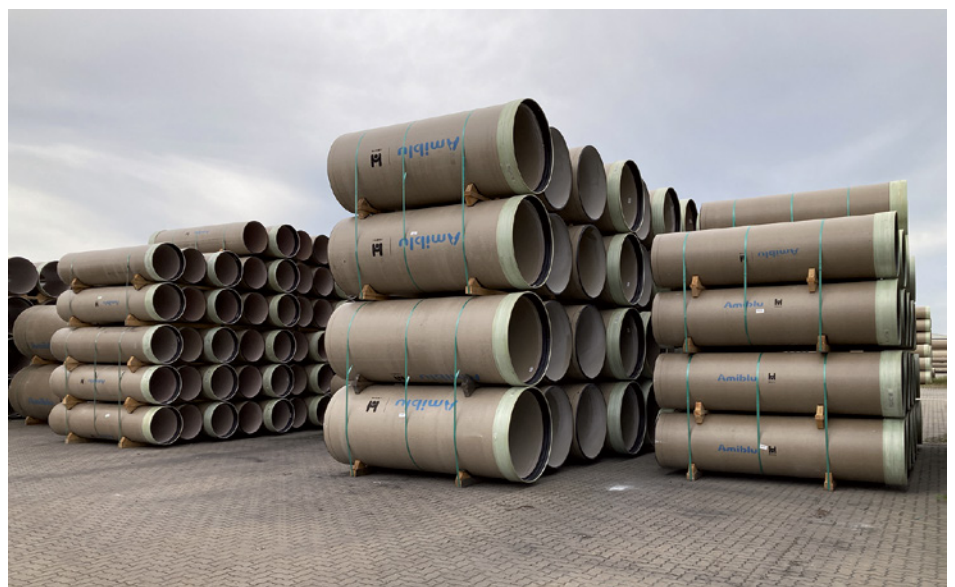
GFK-Rohre werden in verschiedenen Nennweiten und Längen im Schleudergussverfahren produziert – seit 2024 unter Verwendung von Produktionsreststoffen.
