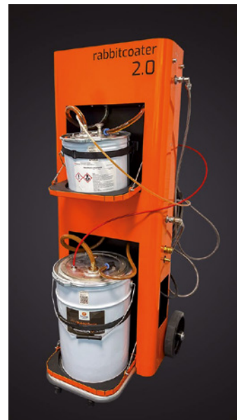
Der Rabbitcoater 2.0 – schlanker, leichter und direkt mit Harz- und Härter-Eimern statt Tanks
