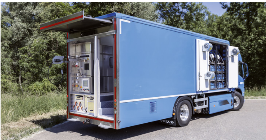
Kürzlich erstmals ausgeliefert: die weltweit erste vollständig elektrisch betriebenen UV-Anlage | Fotos: Prokasro
