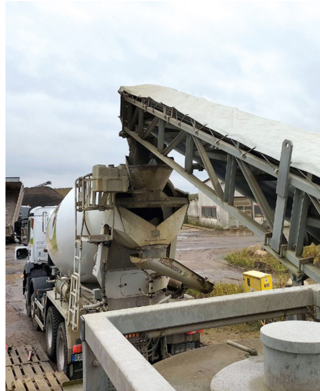
Der Boden gelangt über ein Förderband unter Zugabe von Compound, Zement und Wasser in den Trommelmischer, wo die Vermischung stattfindet. | Foto: B_I/Valdix
