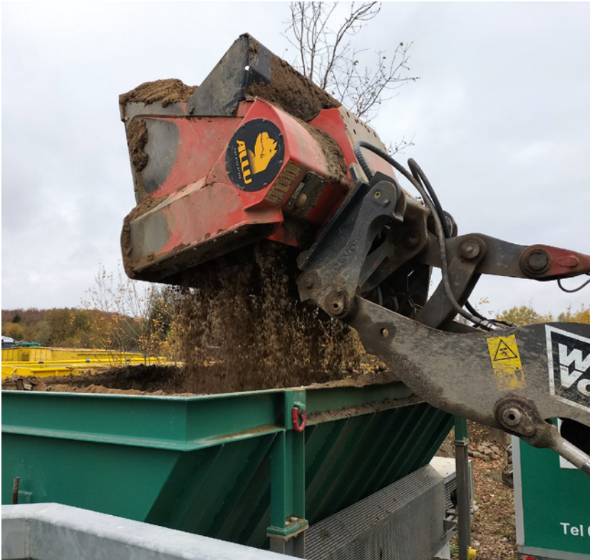
Der Boden gelangt über ein Förderband unter Zugabe von Compound, Zement und Wasser in den Trommelmischer, wo die Vermischung stattfindet. | Foto: B_I/Valdix
