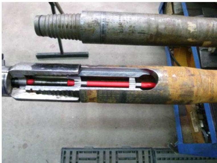
4 und 5: Mittig im Bohrgestänge verläuft in einem stabilen Glasfaserstab, sternförmig im Gestänge aufgehängt, ein leistungsfähiges Datenübertragungskabel, welches bei Verschrauben der Gestängemuffen automatisch mitverbunden wird
