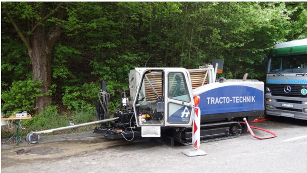
6: Grundodrill-Bohrgerät 15N mit speziellen Orfeus-Bohrkopf (hinter der weißen Kunststoff-Abdeckung sitzen die Radarantennen) im Einsatz in Stuttgart
