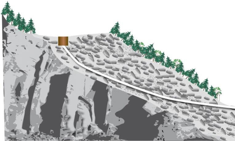
10: Schemaskizze zum Verlauf der oberen Dränagebohrung im Auchttert-Hang
